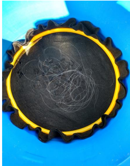
Foto 2. Instalación de geotextil sobre el lecho de arena por medio de aro de plástico.
