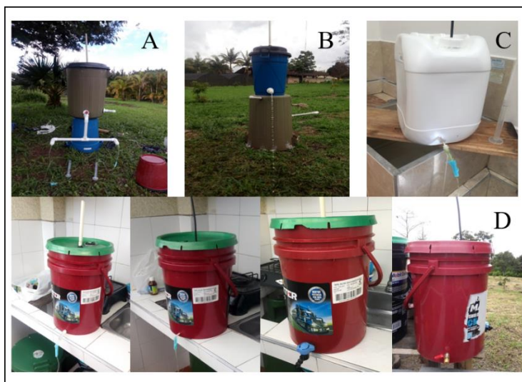
Figura 13. Evaluación del método del frasco de Mariotte a escala piloto (A) tanque de 120 L con salida doble; (B) tanque de 60 L; (C) bidones de 25 L; (D) Tanques rígidos herméticos 25 L evaluados en diferentes configuraciones.
