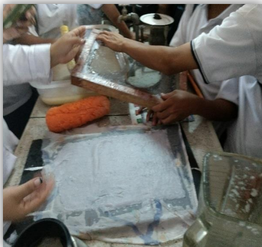
Figura 18. Fabricación de papel reciclado
