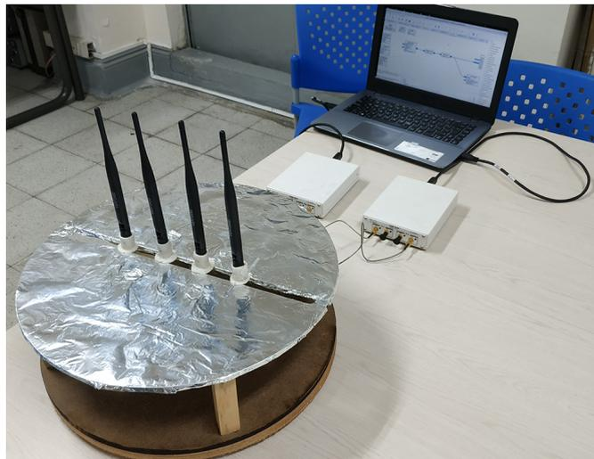
Figura 3.1: Implementación del arreglo lineal sin reflector.
