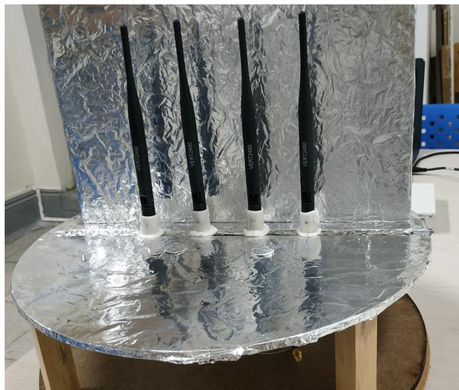
Figura 3.2: Implementación del arreglo lineal con reflector.
