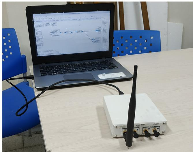
Figura 3.4: Implementación de la estación receptora.
