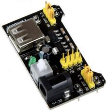
Este módulo de alimentación de referencia YwRobot Power MB V2 permite a partir de una entrada de 6,5V a 12V seleccionar salidas de 3,3V, +5V y una de 5V por conector USB. Este es un módulo de suministro de energía para circuitos electrónicos o en placas perforadas, que simplifica la alimentación.
