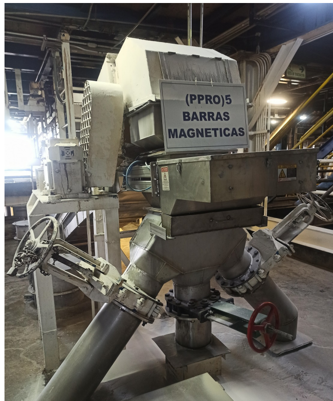
Figura 3.2: Sistema de transporte y barras magnéticas en Ingenio La Cabaña S.A Fuente: Elaboración propia
