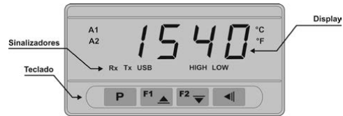
Figura 05 - Identificación de las partes del panel frontal
