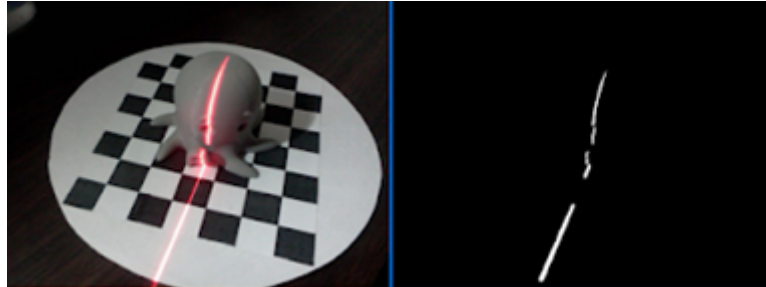
Figura 4.3: Funcionamiento de un telémetro Láser de Escaneo o Barrido. Elaborada por el autor.
