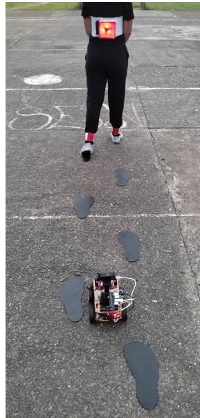
Figura 10.7: Robot siguiendo a una persona para el cálculo de ancho y largo de paso en la Prueba 4.
