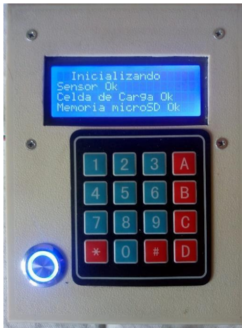
Figura 5.3. Implementación de la PCB con los periféricos. Fuente: Elaboración Propia
