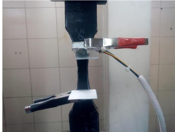
Figura 5.6. Instalación del sensor de distancia. Fuente: Icobandas S.A.
