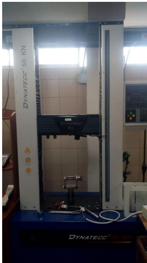
Figura 3.1. Dinamómetro utilizado en las pruebas de calidad en Icobandas S.A. Fuente: Icobandas S.A.
