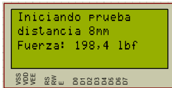
Figura 4.3. Prueba de fuerza en pantalla LCD. Fuente: Elaboración Propia.
