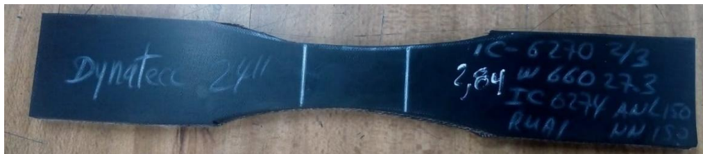
Figura 1.3. Muestra de una banda de caucho para pruebas de rotura. Fuente: Icobandas S.A.
