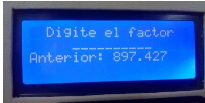
Figura 5.10. Calibración de la celda de carga. Fuente: Elaboración Propia.
