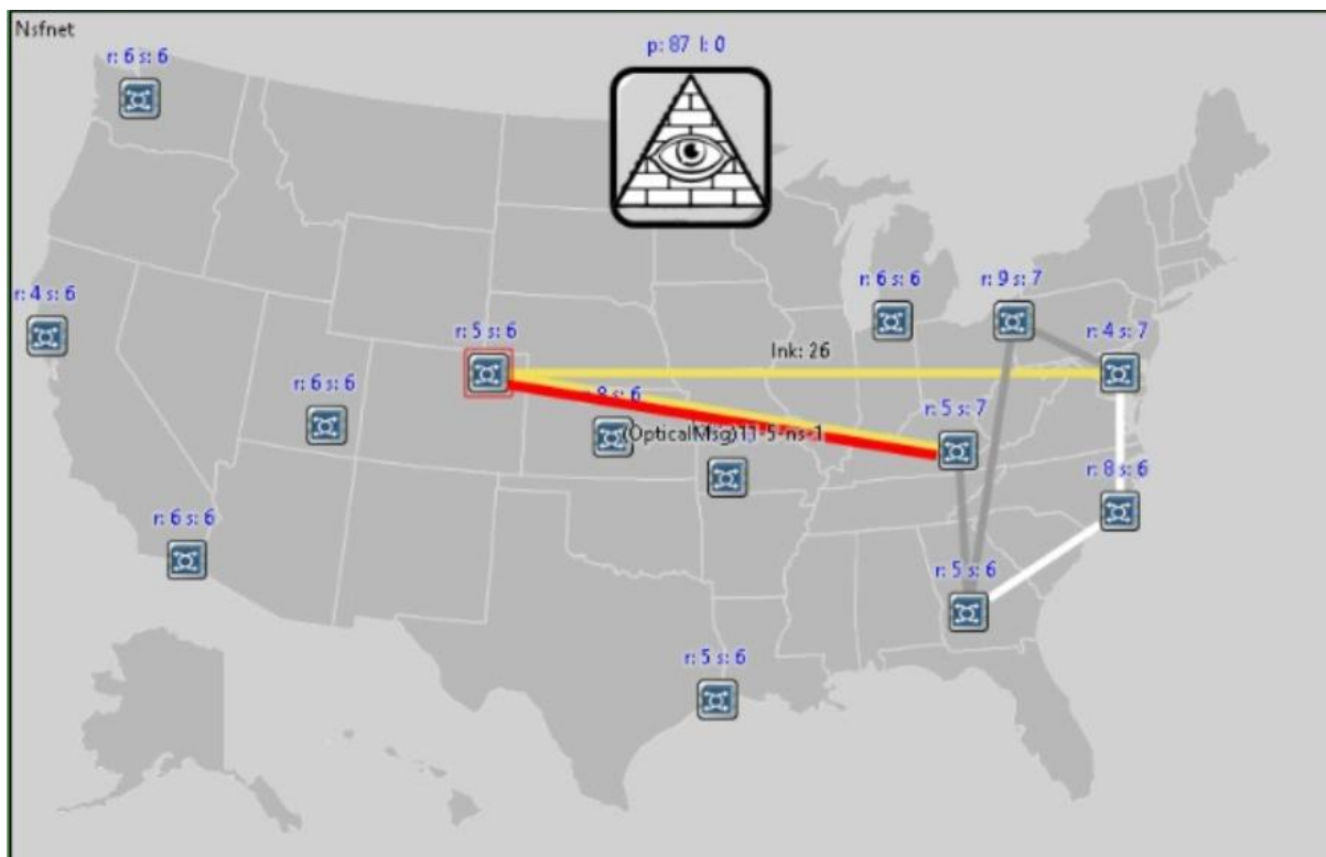
Figura 4.15 Topología SDON Flexigríd. Obtenido de OMNET ++
