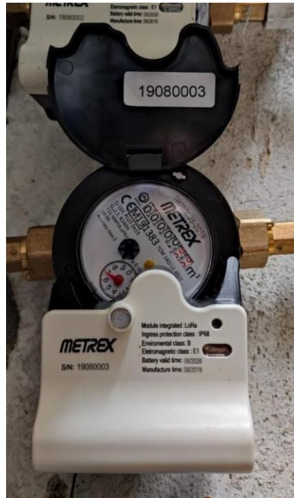
Figura 26. Medidor de agua y módulo de comunicación LoRa ensamblados. Fuente propia.
