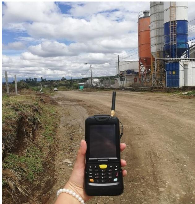
*Figura 62. Prueba de conectividad con medidor AMR 19080050 a 2Km de distancia. Fuente propia.*
