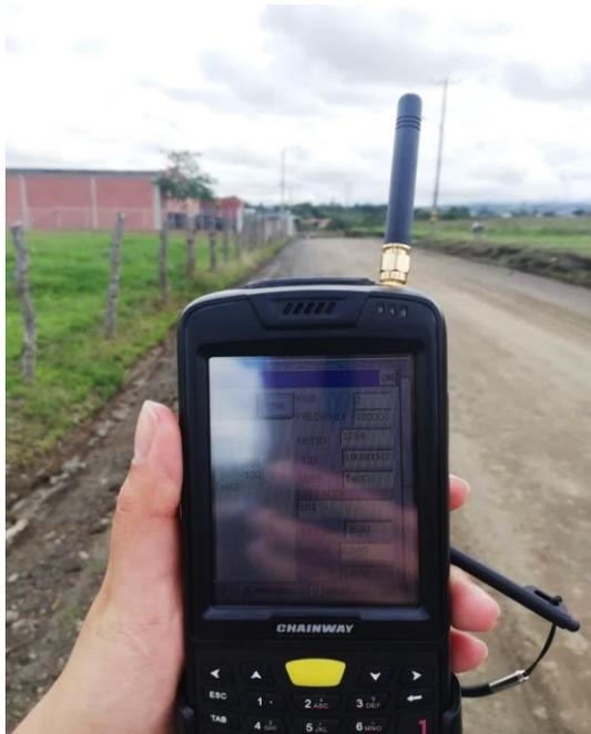
*Figura 59. Prueba de conectividad con medidor AMR 19080047 a 1km de distancia. Fuente propia.*
