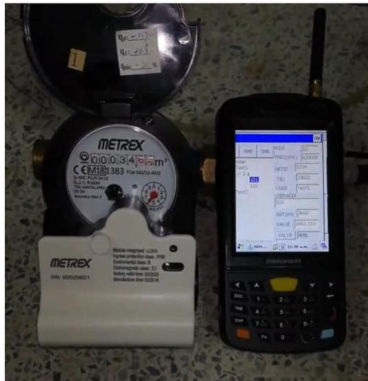
Figura 37. Lectura del valor registrado en el medidor empleando la PDA. Fuente propia.
