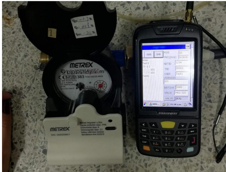
Figura 48. Prueba de consumo con medidor de agua AMR. Fuente propia.
