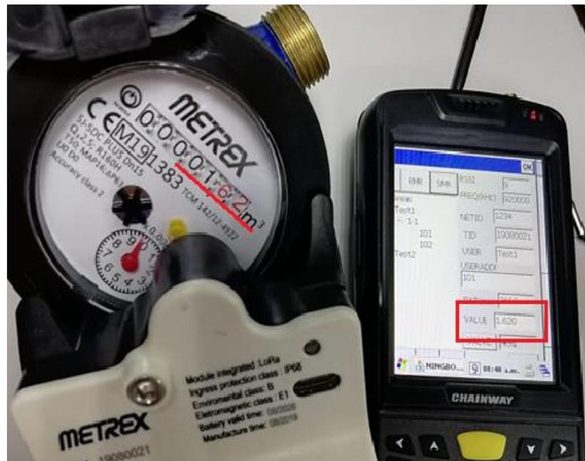
Figura 31. Verificación de sincronía entre medidor y módulo de comunicación. Fuente propia.
