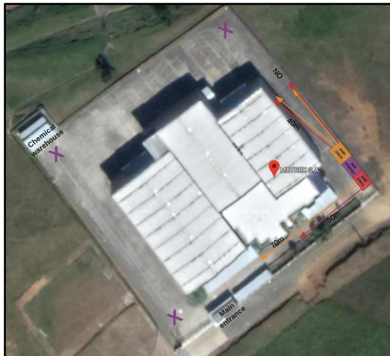
Figura 43. Prueba de conectividad con medidores AMR a diferentes distancias. Fuente propia.
