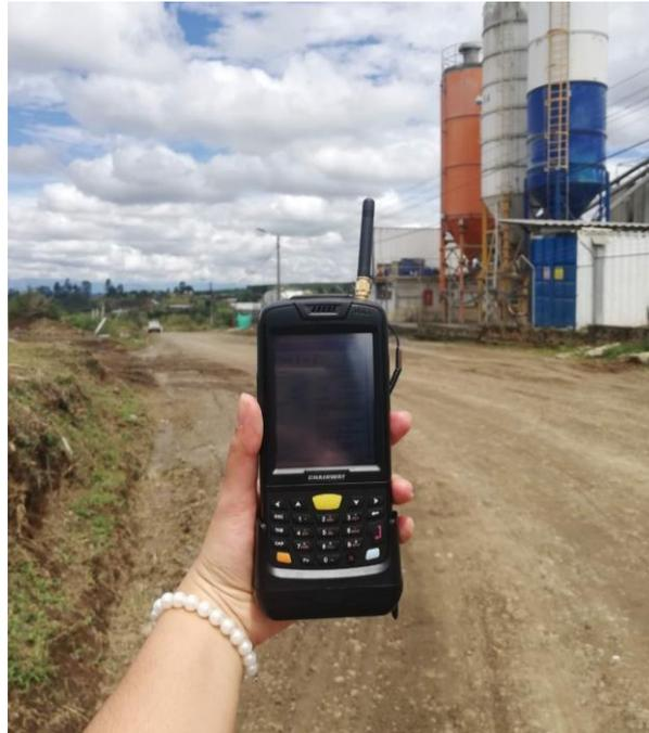
*Figura 61. Prueba de conectividad con medidor AMR 19080047 a 2Km de distancia. Fuente propia.*
