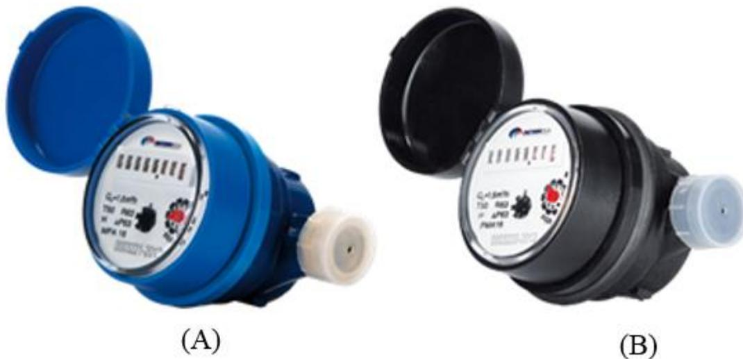
Figura 12. Medidores de agua mecánicos, tipo velocidad chorro único, con un rango dinámico desde R100 a R160. (A) Medidor con cuerpo en bronce. (B) Medidor con cuerpo en plástico o composite.
