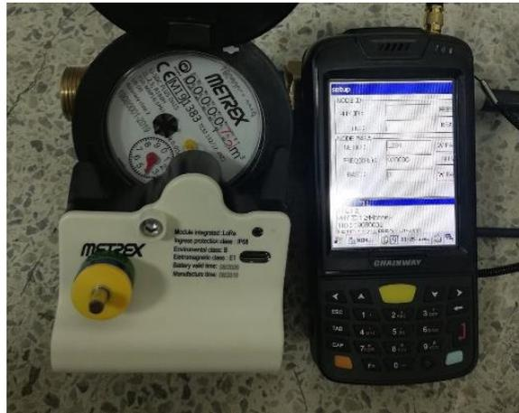
Figura 36. Lectura de parámetros del módulo de comunicación LoRa a través de la PDA.
