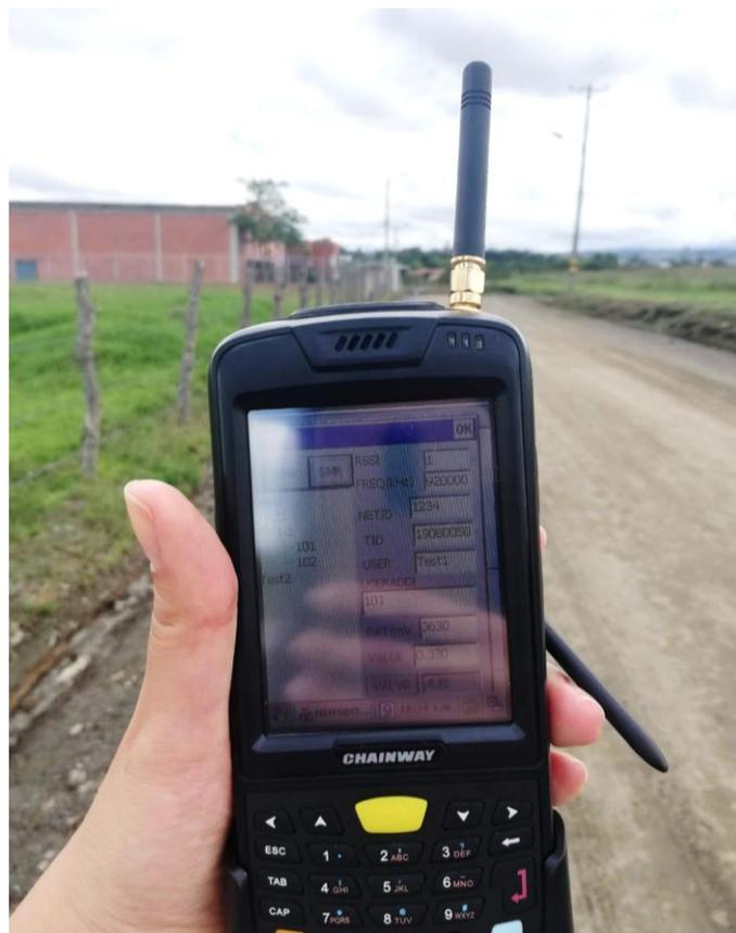
*Figura 60. Prueba de conectividad con medidor AMR 19080050 a 1 km de distancia. Fuente propia.*
