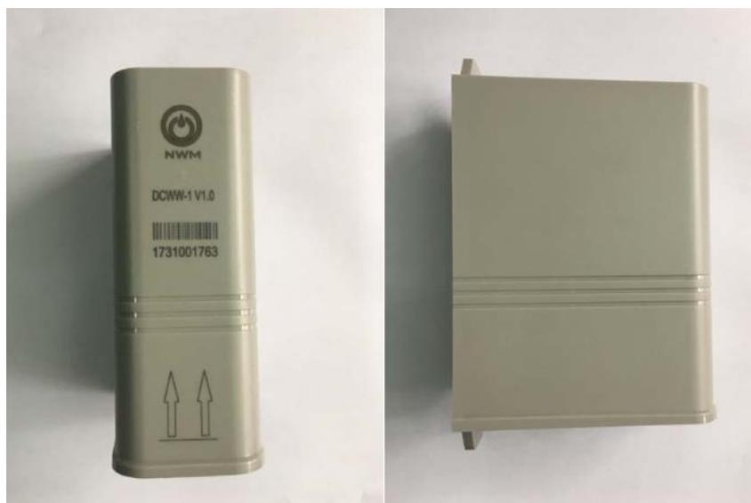
Figura 28. Repetidor de sistema de medición inteligente para medidores agua. Vista frontal y lateral. Fuente propia.
