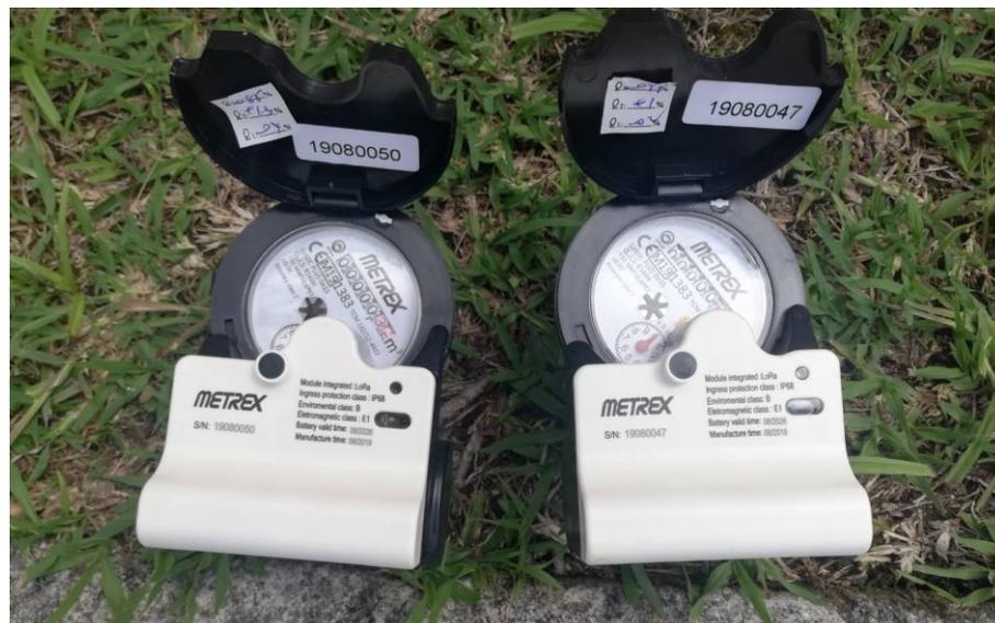
Figura 58. Medidores AMR del nuevo lote ubicados para pruebas de conectividad en campo.
