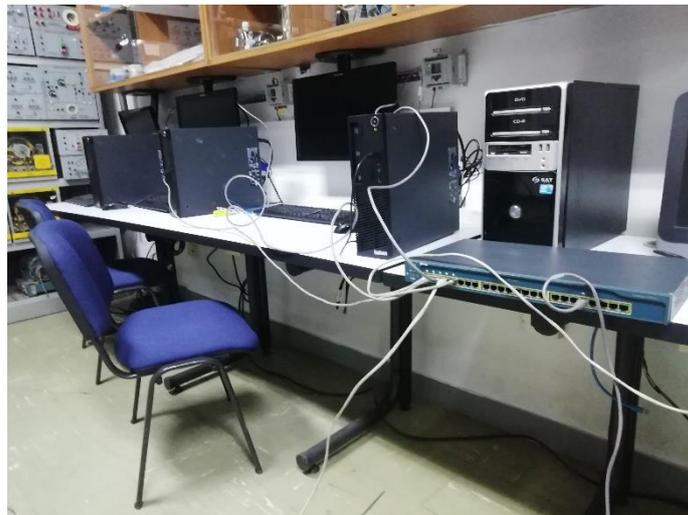
*Figura 70. Evidencia conexión de PLCs MicroLogix 1100 a switch de nivel de Control. (Fuente propia.)*
