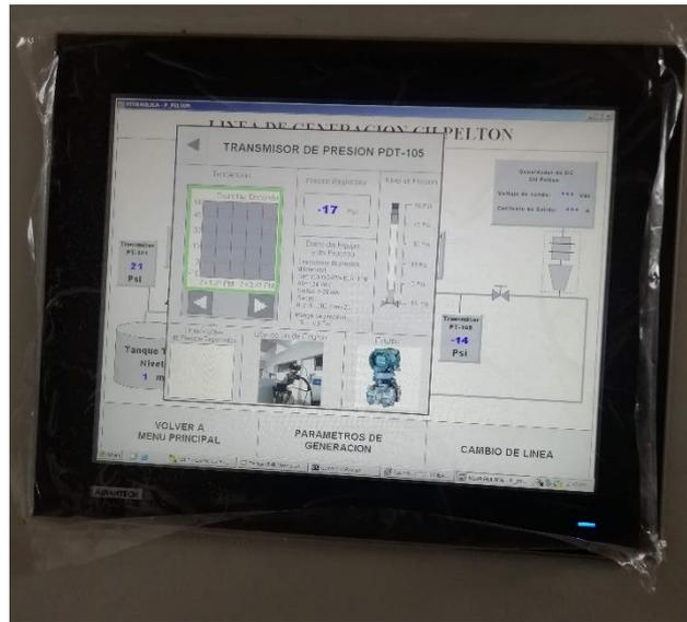
Figura 162. Ejecución de HMI en computador industrial Advantech. Pantalla Transmisor PDT-105. (fuente propia)
