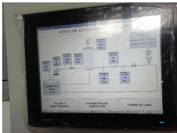
*Figura 161. Ejecución de HMI en computador industrial Advantech. Pantalla línea ChPelton (fuente propia)*
