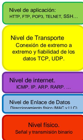
Figura 9. Modelo TCP/IP. Tomado de [9].
