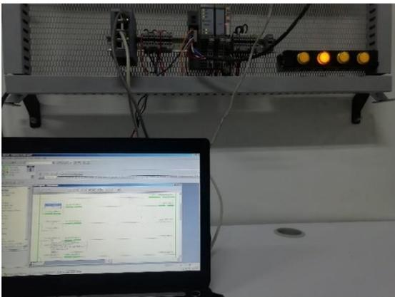
Figura 69. Accionamiento de salidas desde Pulsadores en bus DeviceNet. (Fuente propia.)
