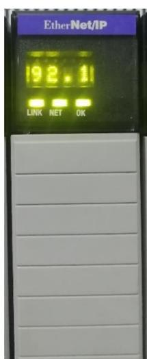
*Figura 89. Dirección IP desplegada en display del módulo 1756-ENBT. (fuente propia)*
