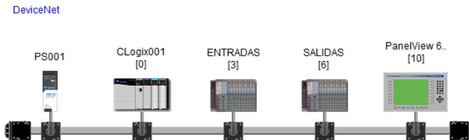
Figura 23. Diseño de red DeviceNet. fuente Propia.
