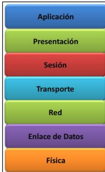
Figura 8. Modelo OSI de 7 capas, tomado de [9].
