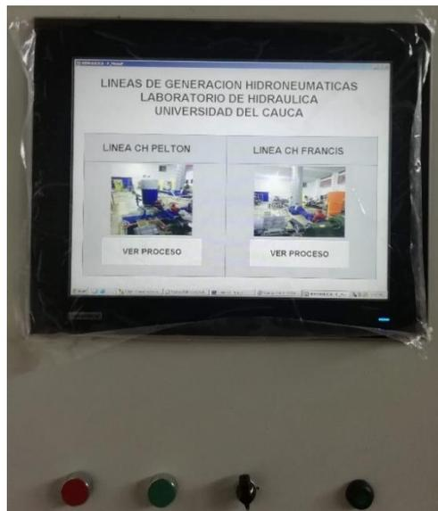
*Figura 160. Ejecución de HMI en computador industrial Advantech. Pantalla inicial (fuente propia)*
