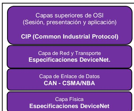
Figura 14. Estructura en capas de red *DeviceNet*. Datos tomados de [14]
