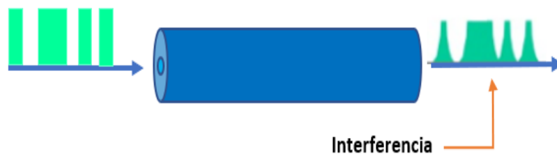
Figura 1.26. Ampliación y compresión de pulsos debido a SPM [54].
