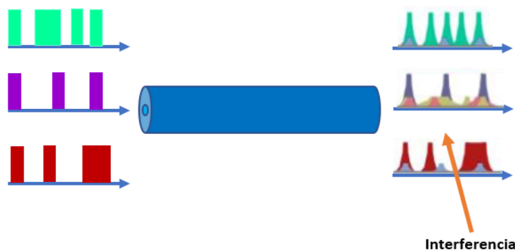
Figura 1.27. XPM sobre tres canales ópticos [54].
