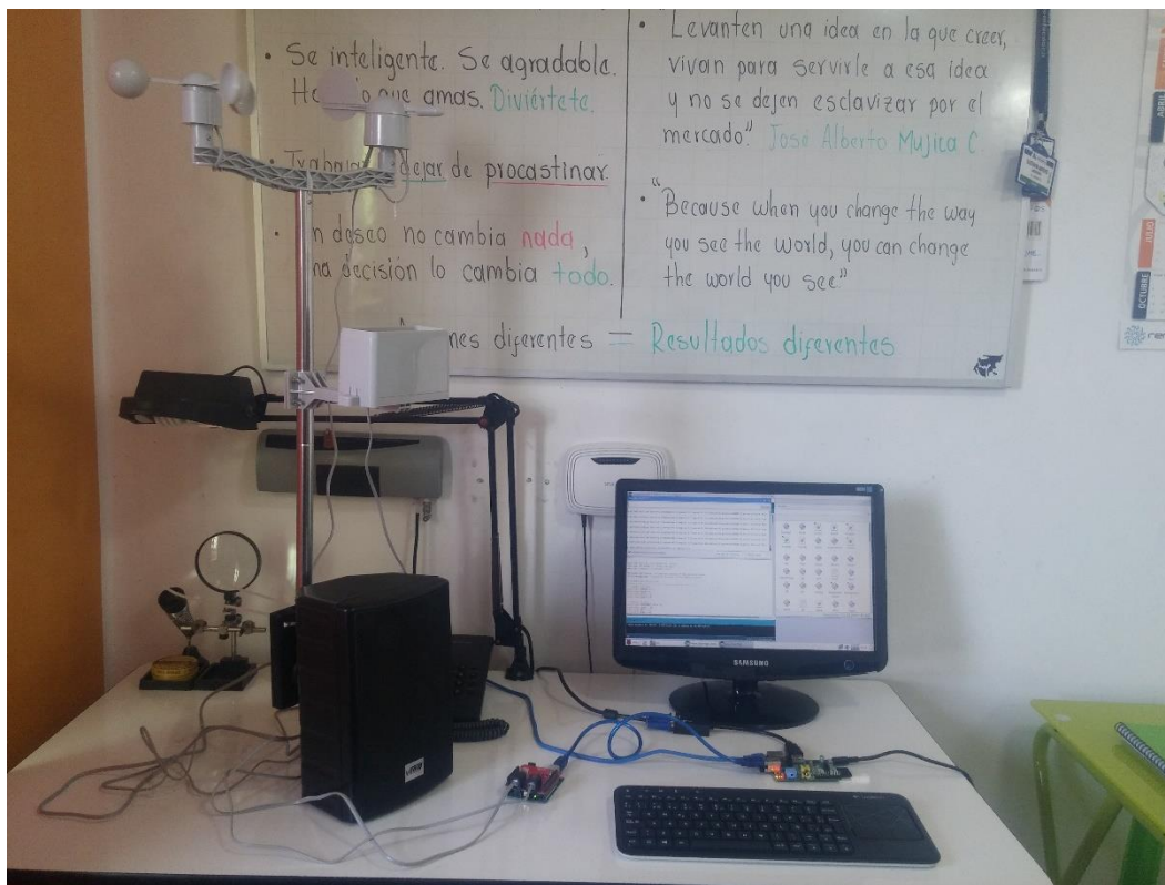
Figura 68. Montaje y pruebas de sensores agroclimatológicos en un entorno simulado para el estudio de caso propuesto.
