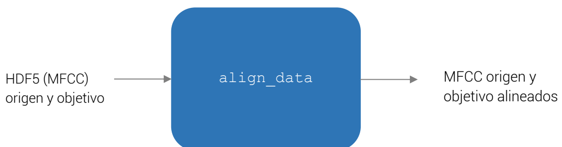
Figura 3. 12. Entradas y salidas de la etapa de estimación de alineamiento de run_sproket.py. Por los autores.
