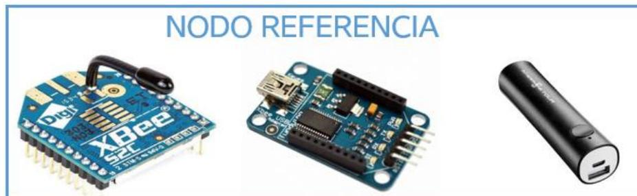
Figura 26: Componentes del nodo referencia.
