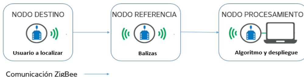
Figura 22: Diagrama general del sistema de posicionamiento en interiores en ZigBee.
