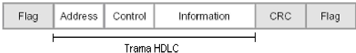
Figura 4.8 Formato de trama HDLC
