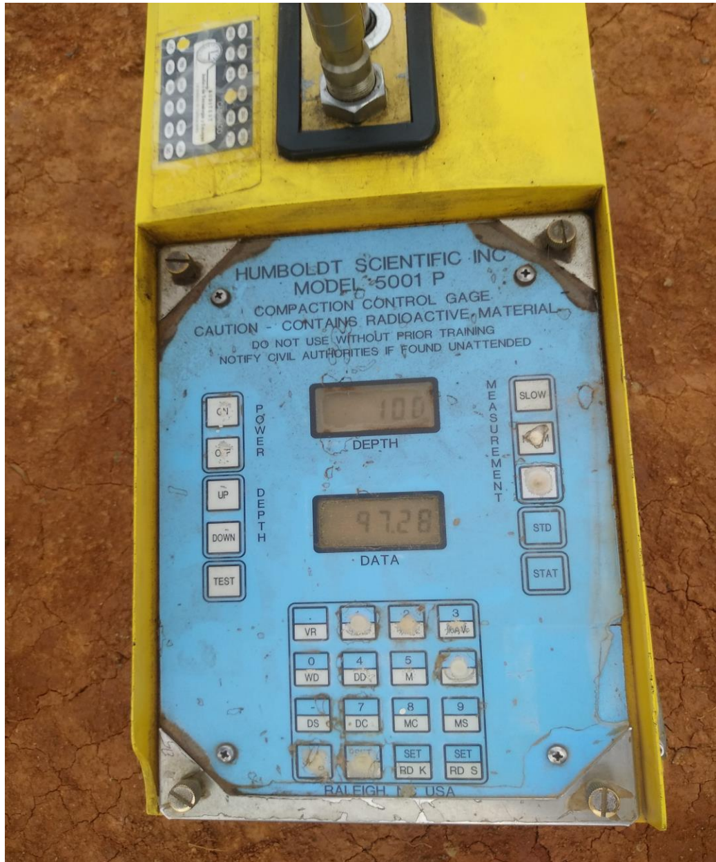
Ilustración 28: Resultado de una de las muestras del densímetro nuclear, la compactación da 97.28% la cual cumple con lo exigido por el diseño. Fuente propia.
