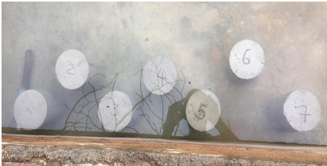
Ilustración 55. Inmersión de especímenes de concreto para ensayos en laboratorio.
