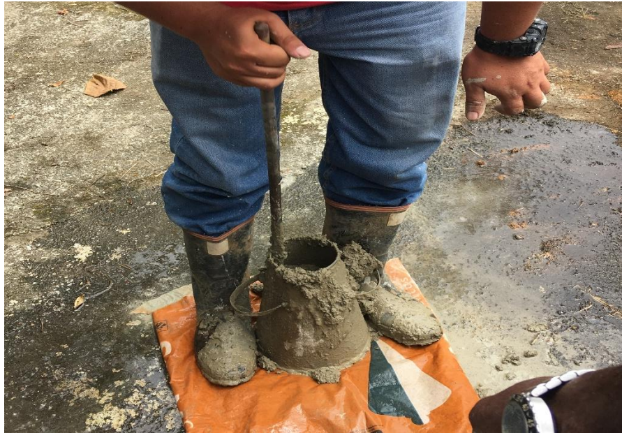
Ilustración 49. Apisonado de primera capa de concreto fresco para prueba de asentamiento.
