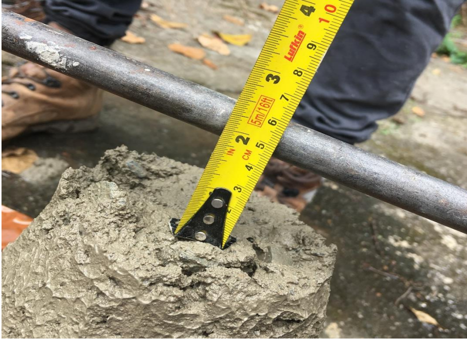
Ilustración 51. Medida del asentamiento para el control de la calidad del concreto.
