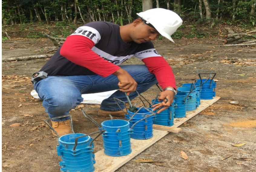
Ilustración 52. Limpieza de los recipientes cilíndricos para muestras de concreto con gasolina.
