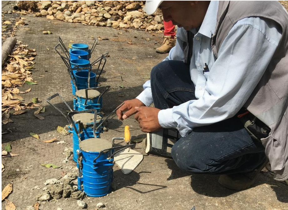
Ilustración 54. Enrase y marcación de los especímenes de concreto fresco.
