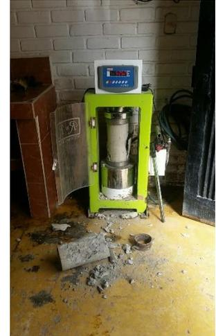
*Ilustración 34 Falla de cilindros en laboratorio*
