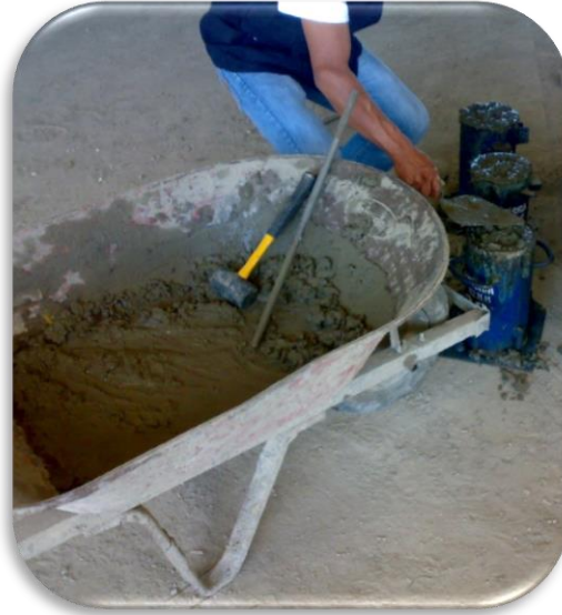
Ilustración 6. Toma de muestras para ensayos de resistencia
