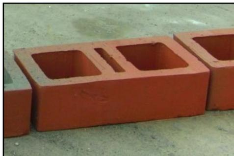
*Figura 12. Ladrillo de perforación vertical.*
