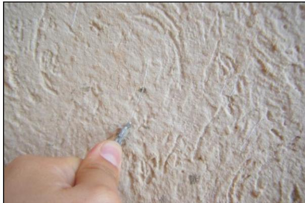
Figura 35. Evaluación de la resistencia de la pintura.
