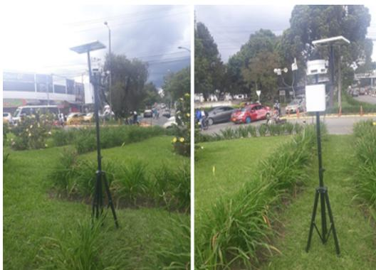
Figura 4.37: Instalación dispositivo de medición, glorieta terminal de transportes. Fuente propia
