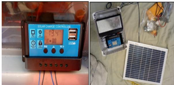
Figura 3.7: Componentes de alimentación con panel solar. Fuente Propia
