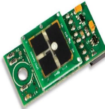
Figura 6.22: Sensor de  $NO_2$ . Fuente: Datasheet del fabricante
