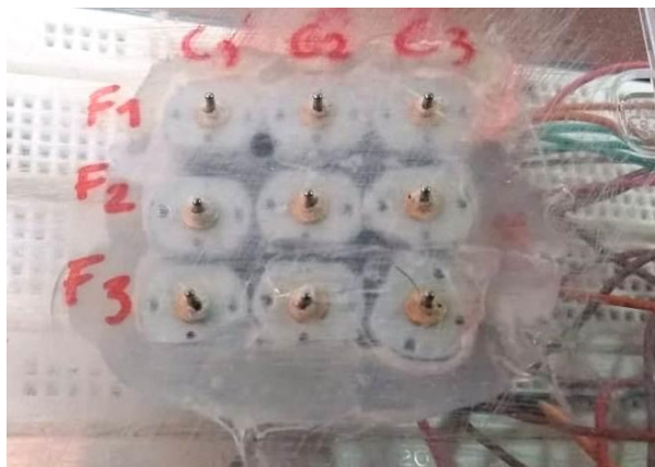
Figura 3.7. Prototipo de mini motores DC.
