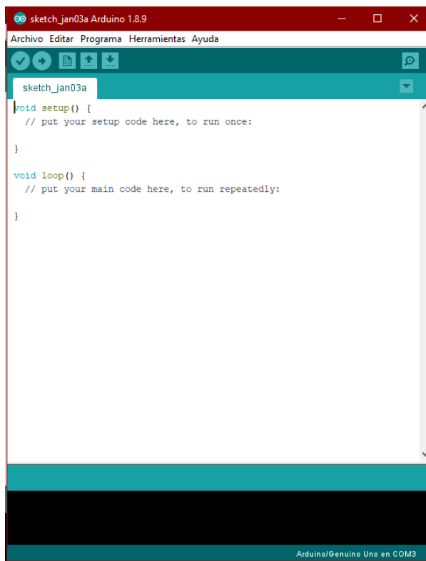
Figura 2.14. Entorno IDE de Arduino.
