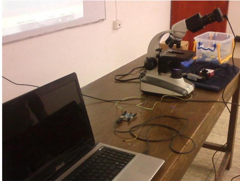
Figura 3.10 Montaje Transmitancia
