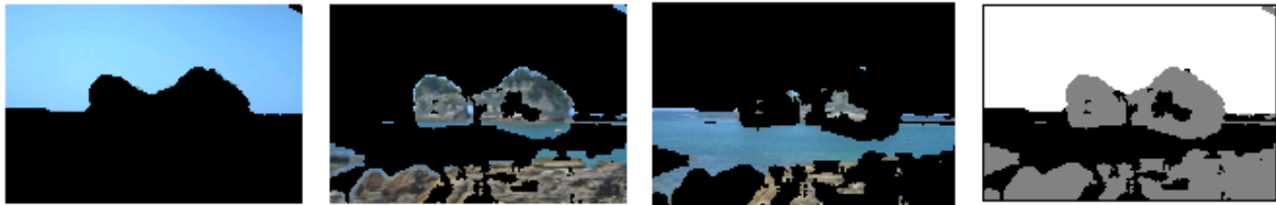
figura 28 Segmentación en 3 regiones y matriz de etiquetas de las imágenes de la figura 27. A pesar del bajo contraste de las texturas el algoritmo es relativamente eficiente en discriminar el cielo, el agua y las rocas en regiones poco compactas.
