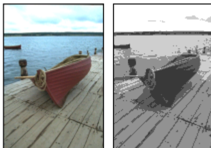
figura 65 Imagen original y matriz de etiquetas proporcionada por el algoritmo de segmentación polinomial.
