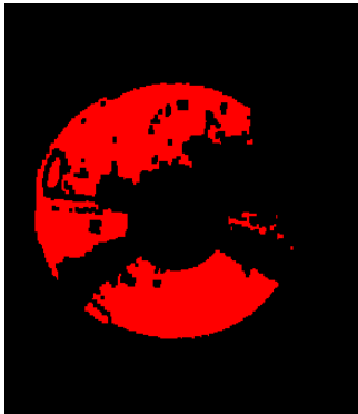
Figura 3.15c. Verificación de huecos en la capa de lectura del disco compacto con rayones en la superficie.
