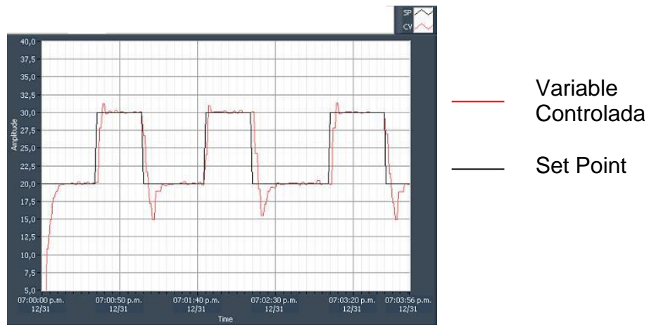
Figura 5.11 Respuesta del proceso de segundo orden con K_c = 10 , T_i = 1 , T_d = 0 .
