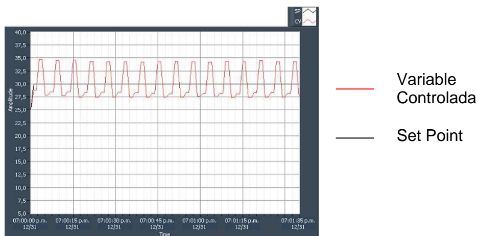
Figura 5.10. Respuesta del proceso con un control ON-OFF con histéresis del 10%
