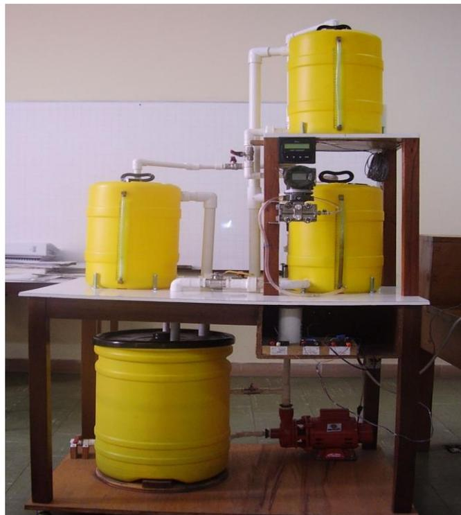
**Figura 10.** Planta de nivel y flujo de agua
