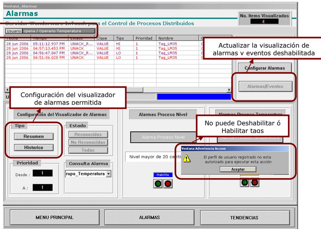
**Figura 44.** Ventana Alarmas, Perfil "Operario Temperatura"
