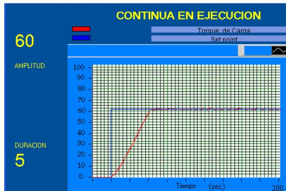
Figura 51: Prueba de lazo cerrado de un tratamiento continuo.
