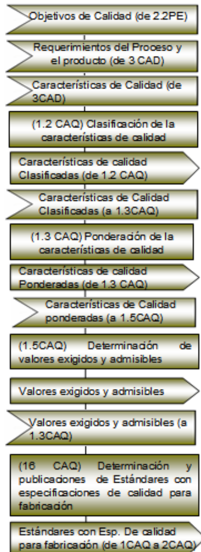
Figura 12. Subprocedimiento Planificación de la Calidad
