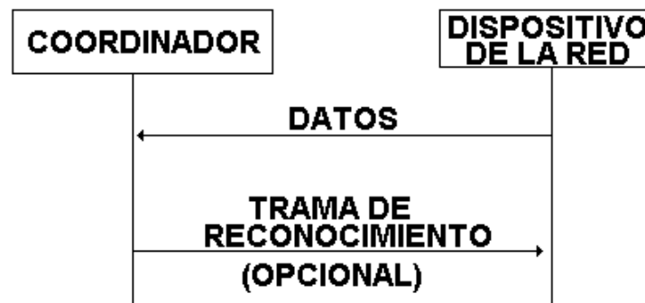
Figura 23. Transferencia de Datos a un Coordinador sin Beacons
