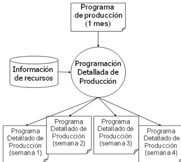
Figura 19. División de un programa de producción en diferentes programas detallados de producción
