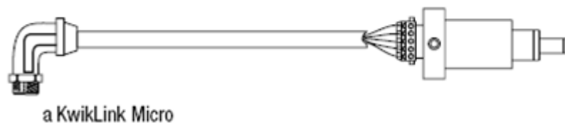
Fig. 19. Cable de derivación 1485K
