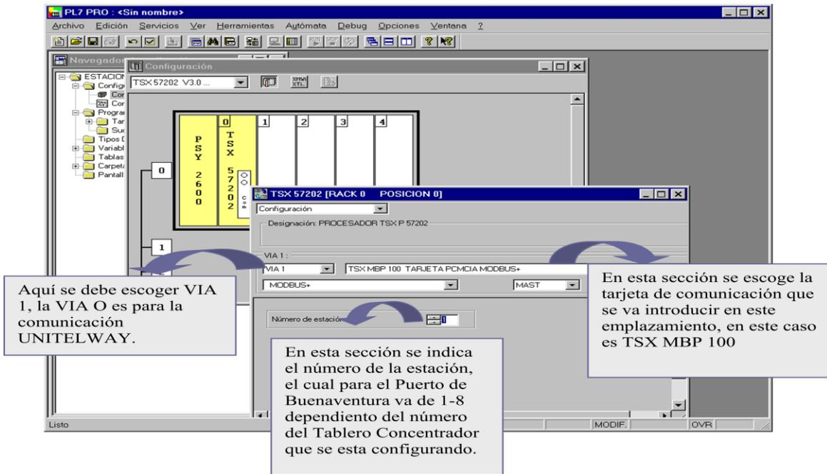
Figura 16.1 Pantalla de configuración de los módulos, Selección Slots
