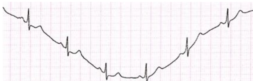
Figura 1.3. Señal ECG contaminada con desplazamiento de línea base. Tomada de [3].
