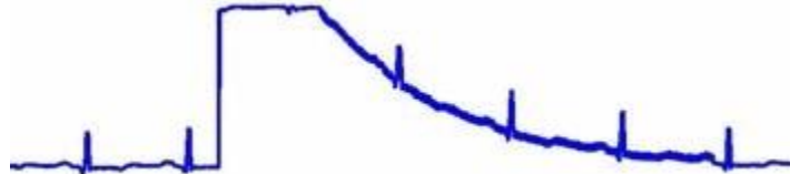
Figura 1.4. Señal ECG contaminada con movimiento de electrodo. Tomada de [4].
