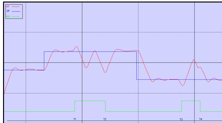
Figura 28: Respuesta de la variable de proceso ante cambios en el setpoint cambios de modo automático a manual y AWBT activado
