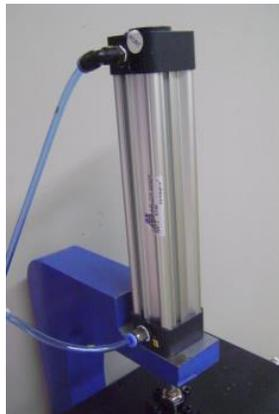
Figura 60. Cilindro de doble efecto.
