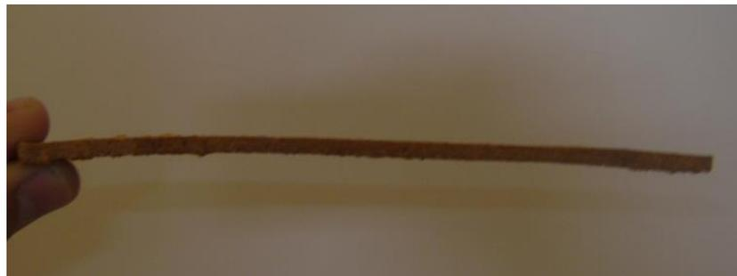
Figura 84. Muestras a 120°C, 20-50 psi y con tiempo de exposición aproximados a 10 min.
