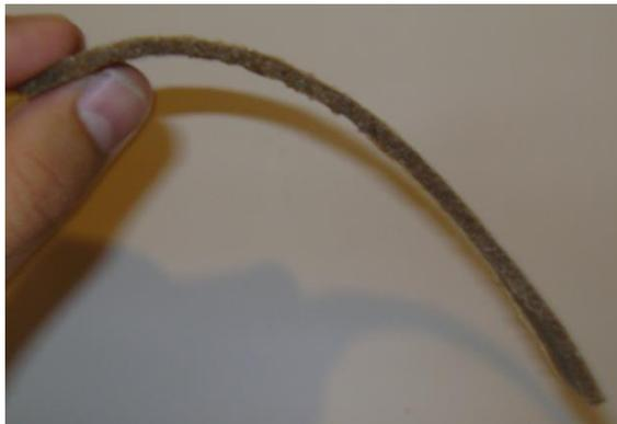
Figura 82. Muestras a 90°C, 50 psi e independiente del tiempo de exposición.
