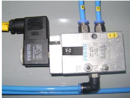
Figura 55. Válvula de 3/2 vías FESTO.
