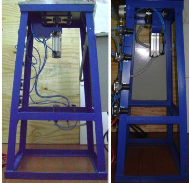
Figura 10. Imágenes de la estructura base terminada. Lado izquierdo: Estructura base vista frontal. Lado derecho: Estructura base vista lateral.
