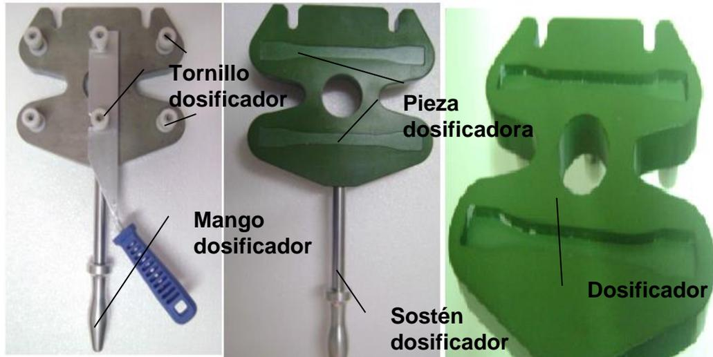
Figura 45. Sistema de dosificación. Izquierda: Imagen cara superior. Centro: imagen cara inferior. Derecha: Acercamiento al dosificador.
