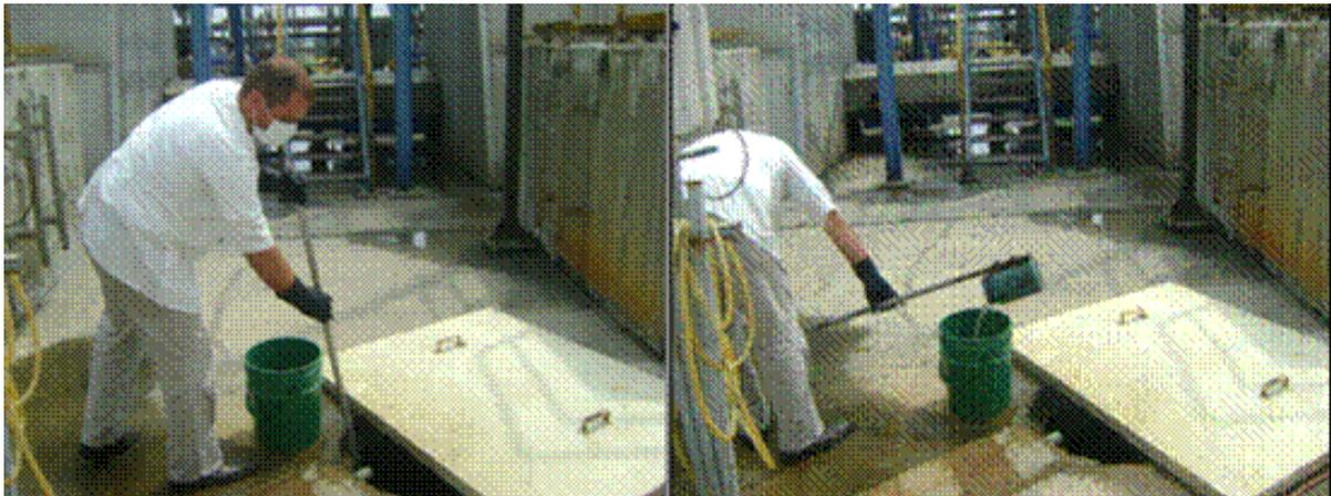
Figura 31. Toma de muestra, cámara de integración PTAR-C.
