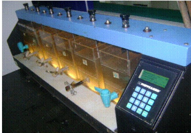
Figura 35. Aparato para la ejecución de la Prueba de Jarras
