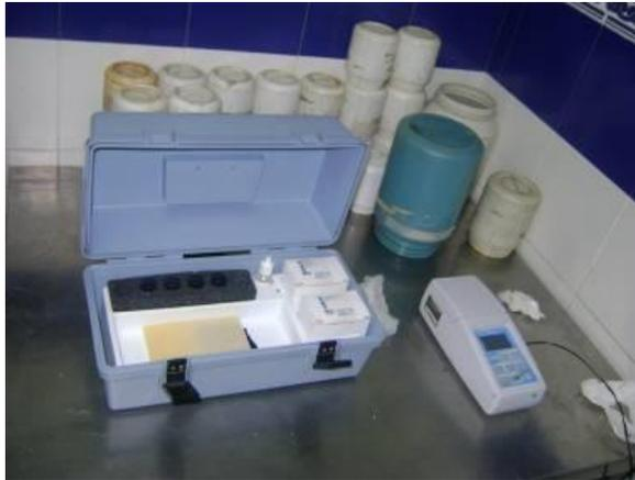
Figura 32. Turbidímetro utilizado para la realización de las pruebas de laboratorio.
