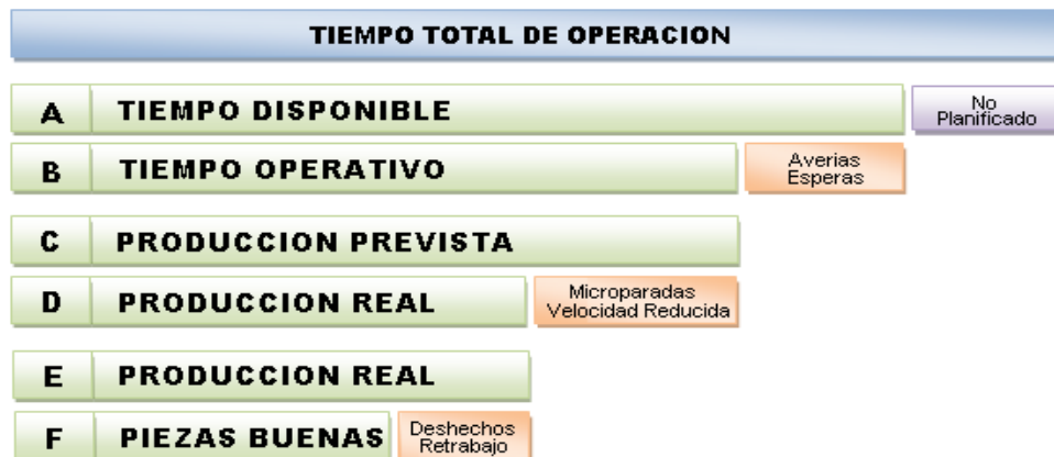
Figura 3. Parámetros de OEE
