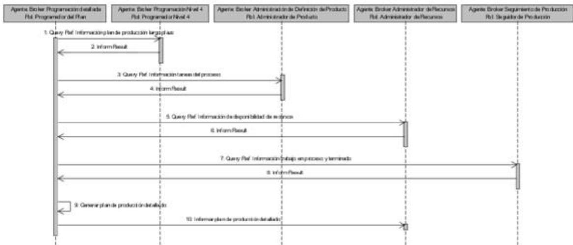
Figura 83. Generación del plan de producción detallado
