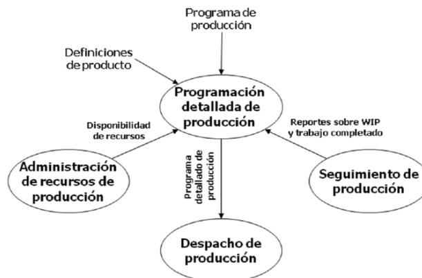
**Figura 27, Interface para la actividad programación detallada de la producción**
