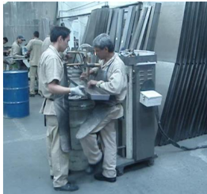
Figura 28. Operario de soldador de punto y asistente
