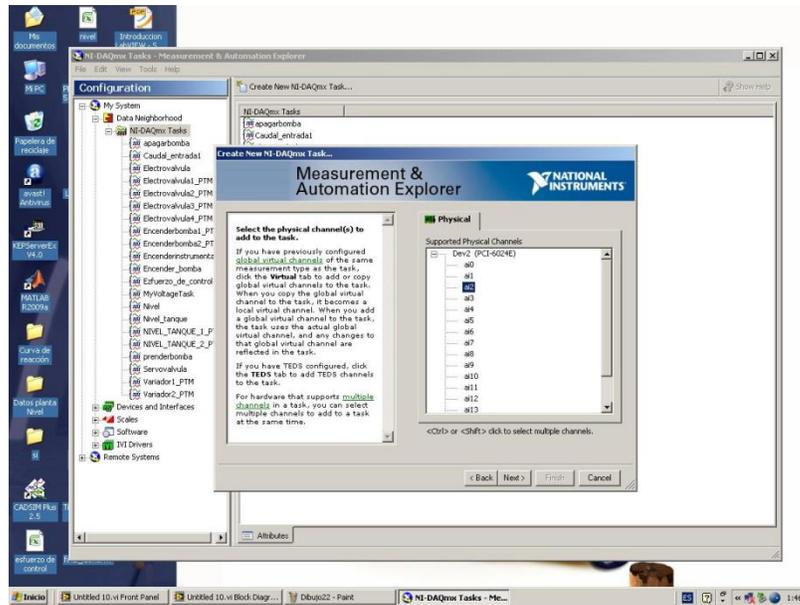
Figura 7. Selección del puerto de conexión de la señal de campo
