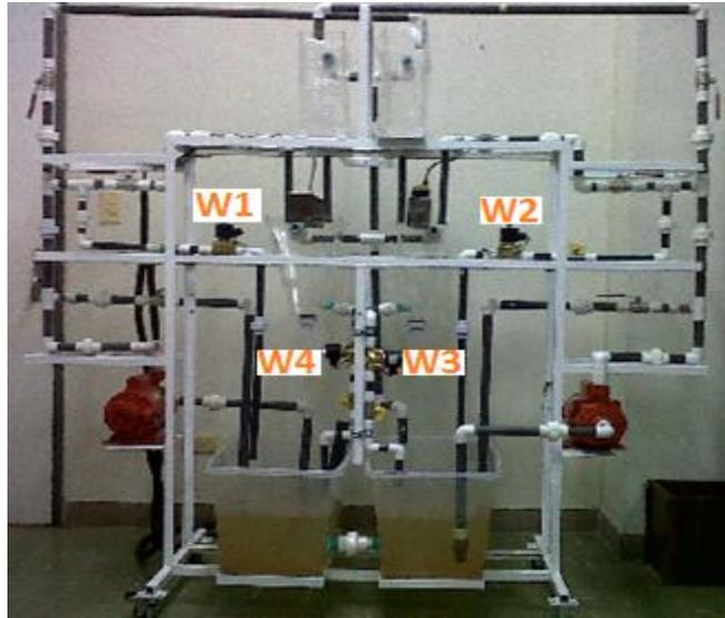
**Figura 49. Planta de Tanques Multivariable – Ubicación de electroválvulas**
