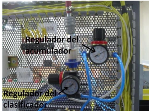
Figura G.7 Regulador de presión del clasificador y regulador de presión del acumulador en el panel trasero del sistema de clasificación.
