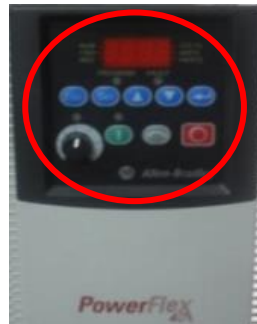
Figura H.23 HMI del variador PowerFlex 40
