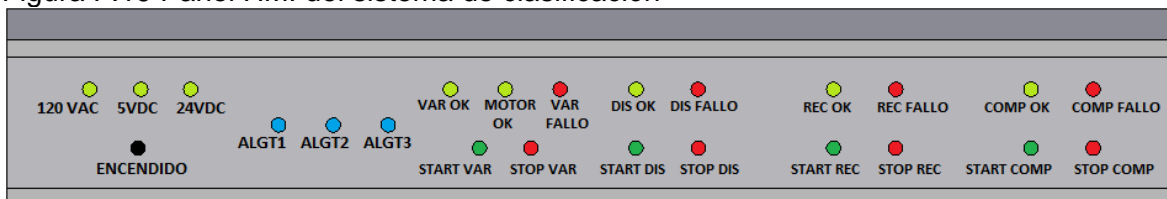
Figura F.19 Panel HMI del sistema de clasificación
