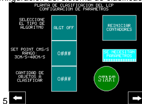
Figura G.14 Pantalla de configuración del sistema de clasificación en Panel View
