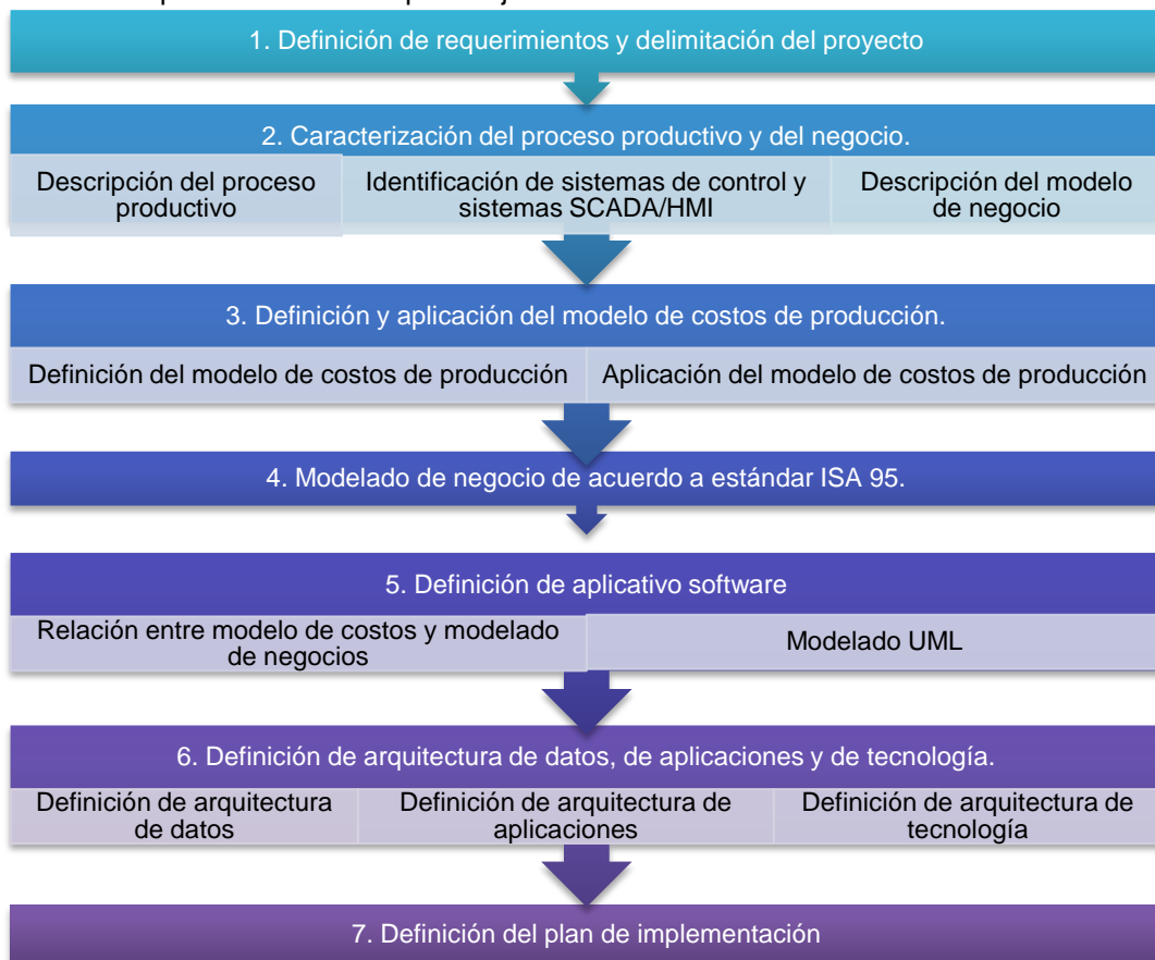
Figura 14. Procedimiento para obtener la desviación entre costos estimados y costos reales de producción en tiempo de ejecución en una industria manufacturera
