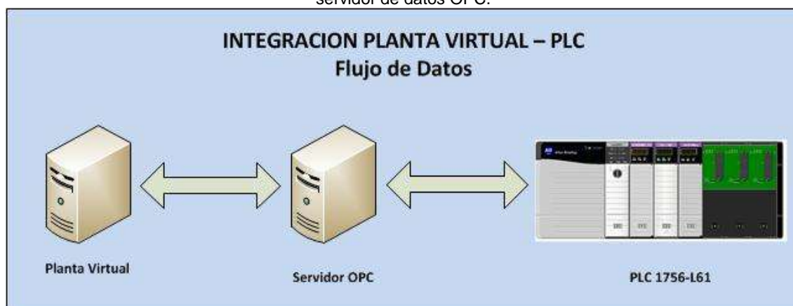
Figura 4.4. Comunicación realizada entre el sistema de control y la planta simulada haciendo uso de un servidor de datos OPC.
