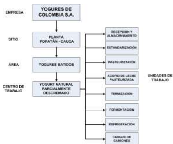
Figura 2.34. Modelo Jerárquico de equipos de la compañía Yogures de Colombia S.A. en su línea de producción de Yogurt Parcialmente Descremado
