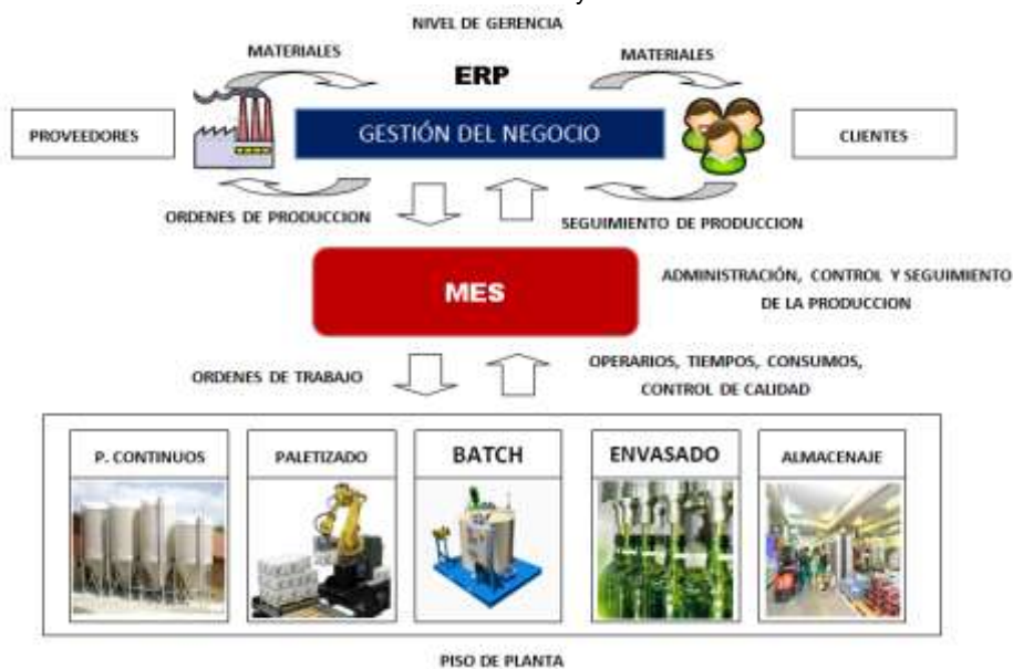
Figura 1.1. Escenario de integración entre los niveles administrativo y de planta de la compañía mediante los sistemas ERP y MES.
