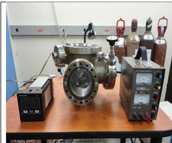
Figura A.5.1 De izquierda a derecha: Indicador de temperatura Eurotherm, Sputtering, Fuente de alimentación del horno DPS-5050
