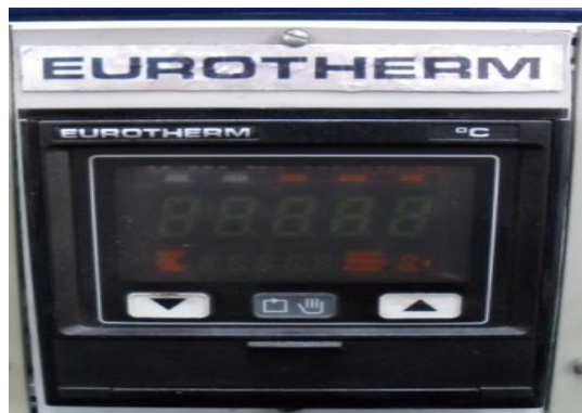
Figura 2.21. Controlador - Indicador de temperatura del horno marca EUROTHERM.
