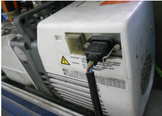
Figura 2.5. Bomba Mecánica ALCATEL 2005SD.
