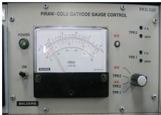
Figura 2.14. Tablero Indicador de presión PIRANI – COLD CATHODE.
