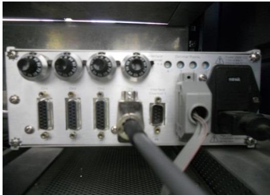
Figura 2.27. Panel posterior del Indicador de flujo de oxígeno con funciones de programación del setpoint MKS 247.
