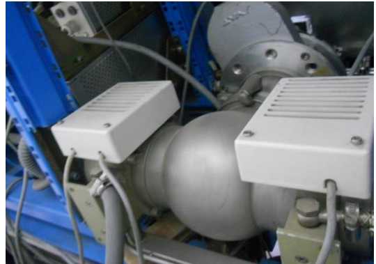
Figura 2.6. Bomba Turbomolecular PFEIFFER TPU 270.
