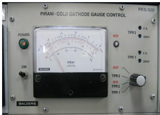
Figura 2.8. Tablero Indicador de Presión PIRANI – COLD CATHODE.
