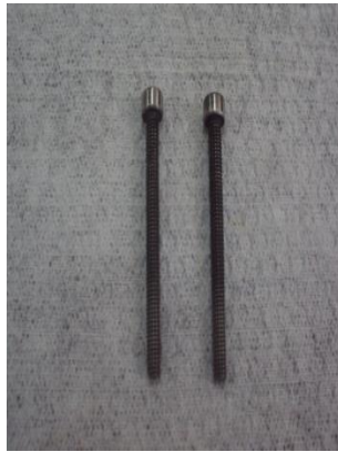
Figura 2.39. Tornillos aseguradores horno – portasustrato.
