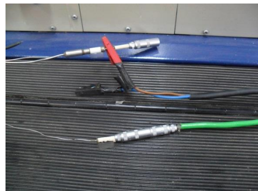
Figura 2.22. Unión de medición - sensor de temperatura de horno (Termocupla tipo J).
