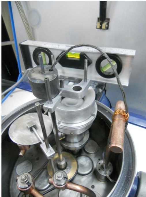
Figura 2.31. Montaje de los componentes internos de la cámara BALZER BAE 250.
