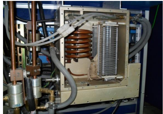
Figura 2.18. Sintonizador de potencia reflejada.
