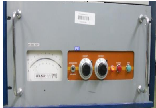
Figura 2.20. Interfaz de mando de V-I de la resistencia del horno.
