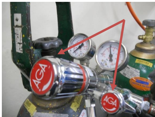
Figura 2.12. Válvula AGA 1 y válvula AGA 2 de la bala de argón.
