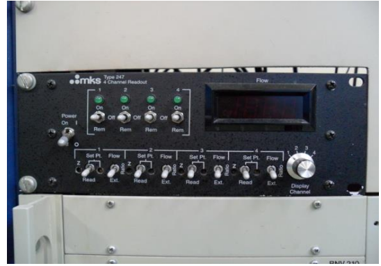
Figura 2.26. Panel frontal del Indicador de flujo de oxígeno con funciones de programación y ajuste del setpoint MKS 247.
