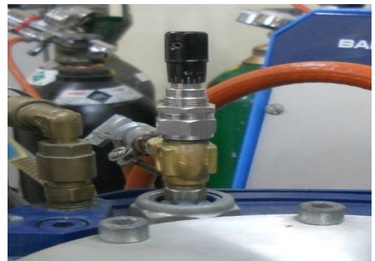
Figura 2.13. Válvula de flujo entrada de argón a la cámara.
