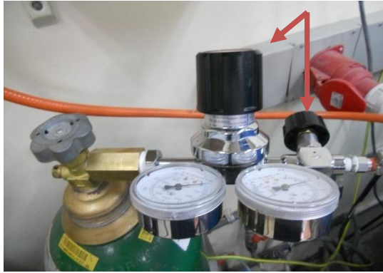
Figura 2.25. Válvula AGA 1 y válvula AGA 2 de la bala de oxígeno.
