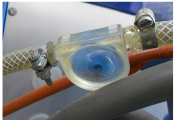
Figura 2.3. Indicador de flujo de entrada de agua a la tapa de la cámara tipo molinete.
