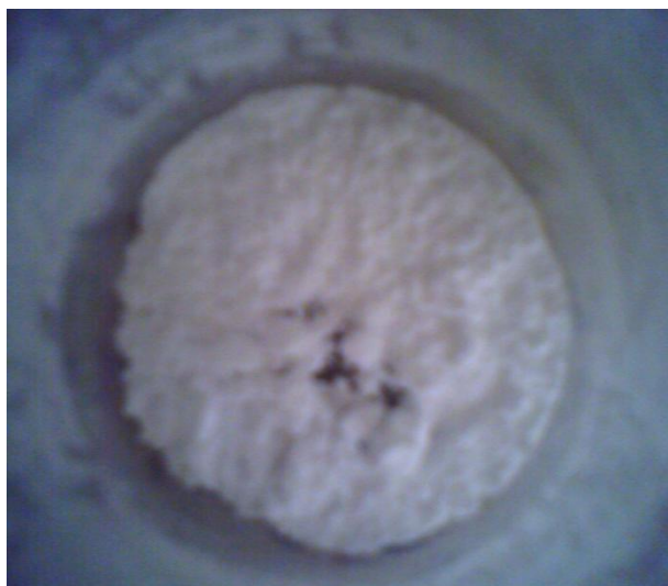
Figura 1.7. Material obtenido al secar a 80° C la suspensión de titanio conformada al finalizar el proceso sol – gel.
