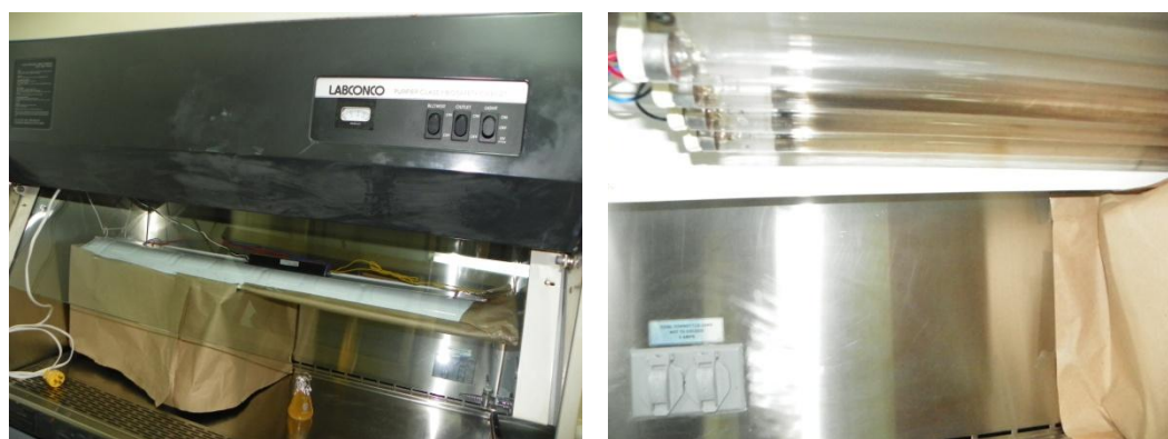
Figura 2.11. Disposición de las lámparas de UV en la cabina de flujo laminar.
