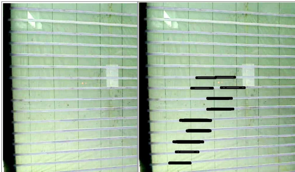
Figura 40. (a) Imagen original, (b) Resultado de búsqueda por plantilla (Template Matching).
